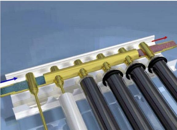
Конденсатор служит для передачи тепла, но он не контактирует с теплоносителем. Тепло передается от конденсатора медному теплообменнику, а затем в проходящую жидкость. Это очень важный момент, чтобы понять, каким образом Вы можете поменять трубки. Трубки при необходимости могут быть заменены без осушения системы.
